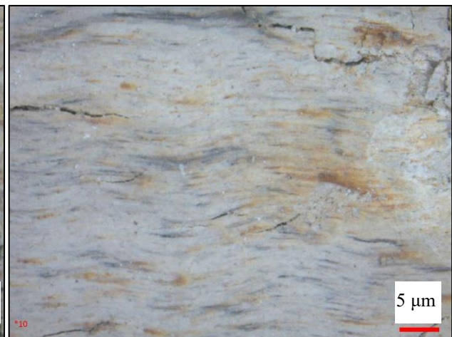
איור 4.1.6.3: תמונה תחת ביניקולר מקידוח K-2, 48-49.1 מטר. הגדלה פי 10. בדוגמא חוואר אפרפר צפוף ומשוכב.
