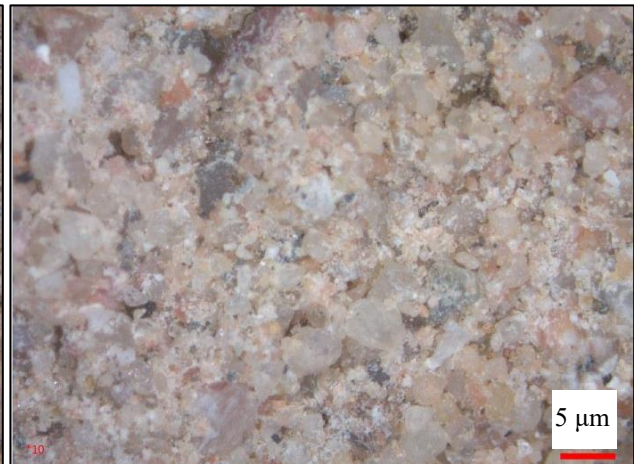
איור 4.1.6.1: תמונה תחת ביניקולר מקידוח K-10, 35.6-36.2 מטר. הגדלה פי 10. בדוגמא פרגמנטים רבים מזוותים שמקורם בגרניט יחד עם מטריקס דק במיוחד קלציטי וגבישי מלח.
