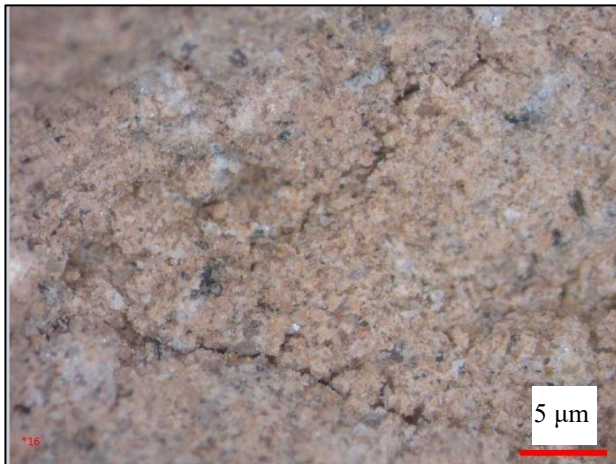
איור 4.1.6.2: תמונה תחת ביניקולר מקידוח K-9, 22.7-24.2 מטר. הגדלה פי 16. בדוגמא פרגמנטים קטנים מאוד. עשיר בקוורץ, יחד עם מטריקס דק במיוחד קלציטי.
