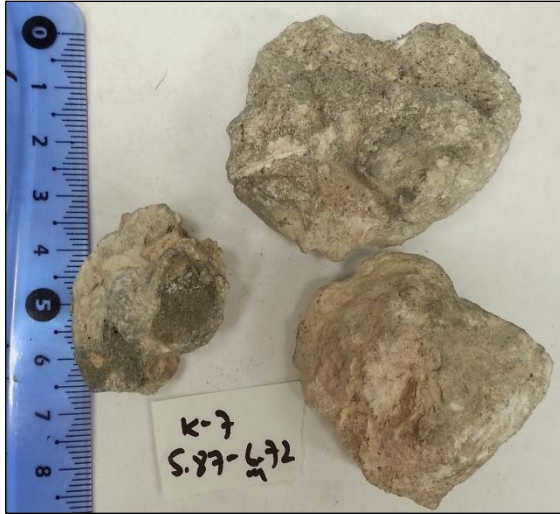
איור 4.1.8.1: דוגמת יד מקידוח K-7 מעומק 5.8-6.7 מטר מתחת לפני הים. חול סילטי דחוס עם חלוקים.
