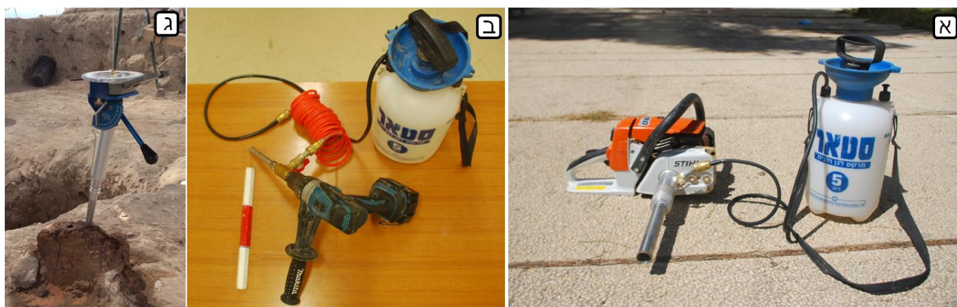
איור 4: דיגום בעזרת מקדחה; א. מקדחה פלאומגנטית מקוררת מים ומופעלת בנזין, ראש הקידוח המורכב בקוטר 1" (צילום: סרגיי ויקנוב); ב. מקדחה פלאומגנטית מקוררת מים חשמלית, ראש הקידוח המורכב בקוטר 0.5" (צילום: סרגיי מיקנוב); ג. Core Orienting Fixture עם מצפן צל שמש למדידת אוריינטציה של קידוח.
